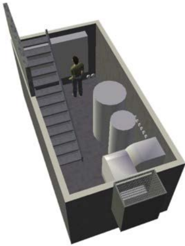
Abb. 13.5: Die Raumzellen sind für die Ein-Mann-Wartung zugelassen, eine zweite Person muss nicht anwesend sein.
