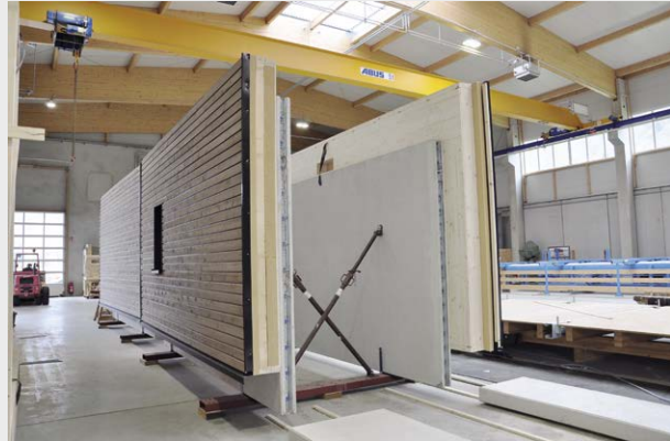
Abb. 16.15: Neuartige Hybridwand in Materialkombination
